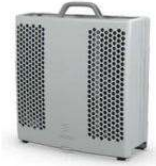
Slika 3.7 Izgled RRUS 12/13 jedinice
