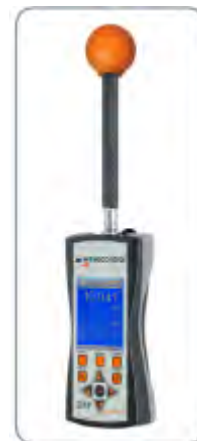
Širokopolasni instrument za merenje jačine el. polja
