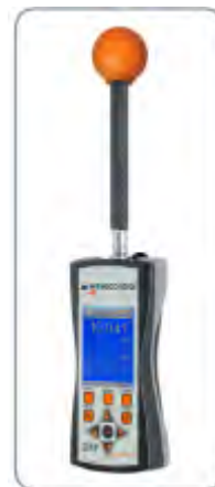
Širokopolasni instrument za merenje jačine el. polja
