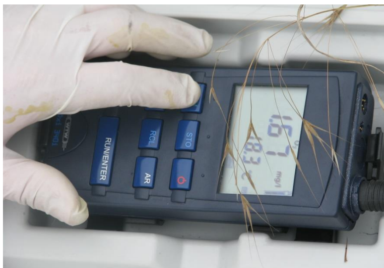
Слика 1. Теренско одређивање концентрације кисеоника
