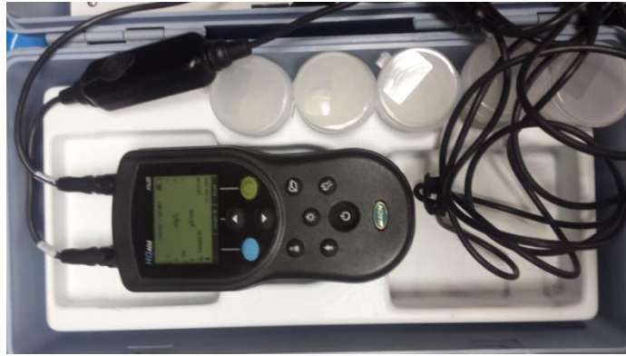
Слика 4. Теренско одређивање концентрације кисеоника
