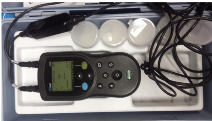
Слика 2. Теренско одређивање концентрације кисеоника
