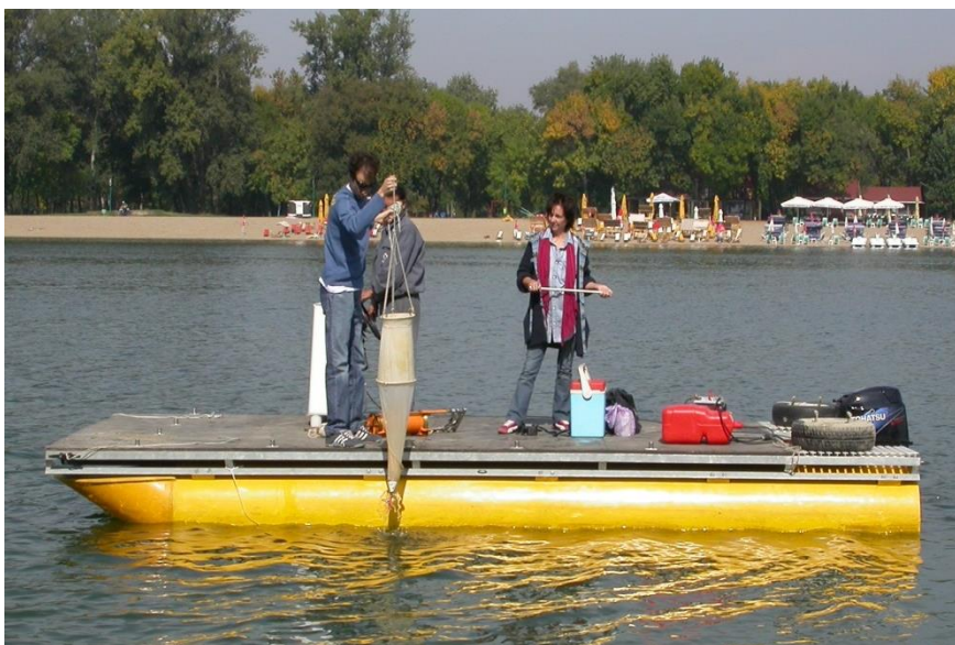
Слика 6. Узорковање воде за биолошка испитивања
