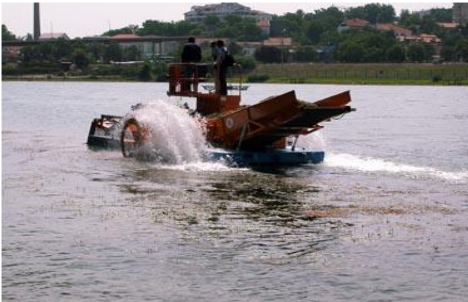
Слика 3. Уклањање макрофитне вегетације кошењем
