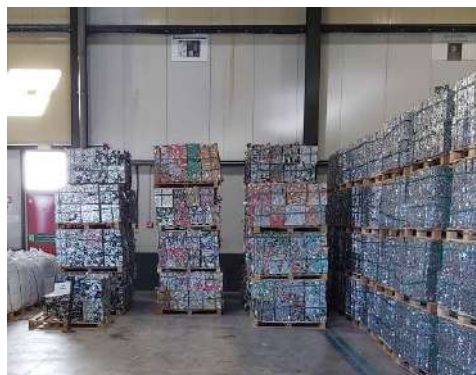
Slika 6. Presovane i balirane otpadne limenke i škart, skladištene po blok sistemu
