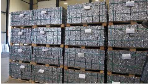
Slika 6. Presovane i balirane otpadne limenke i škart, skladištene po blok sistemu
