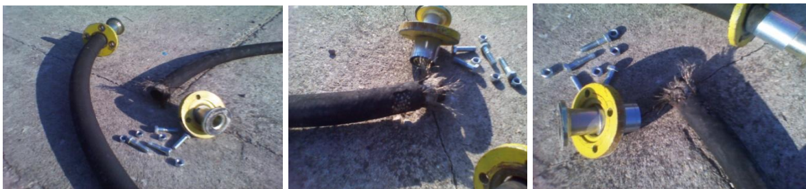
Slika 3.6. – Izgled fleksibilnog creva i priključka nakon udesa
