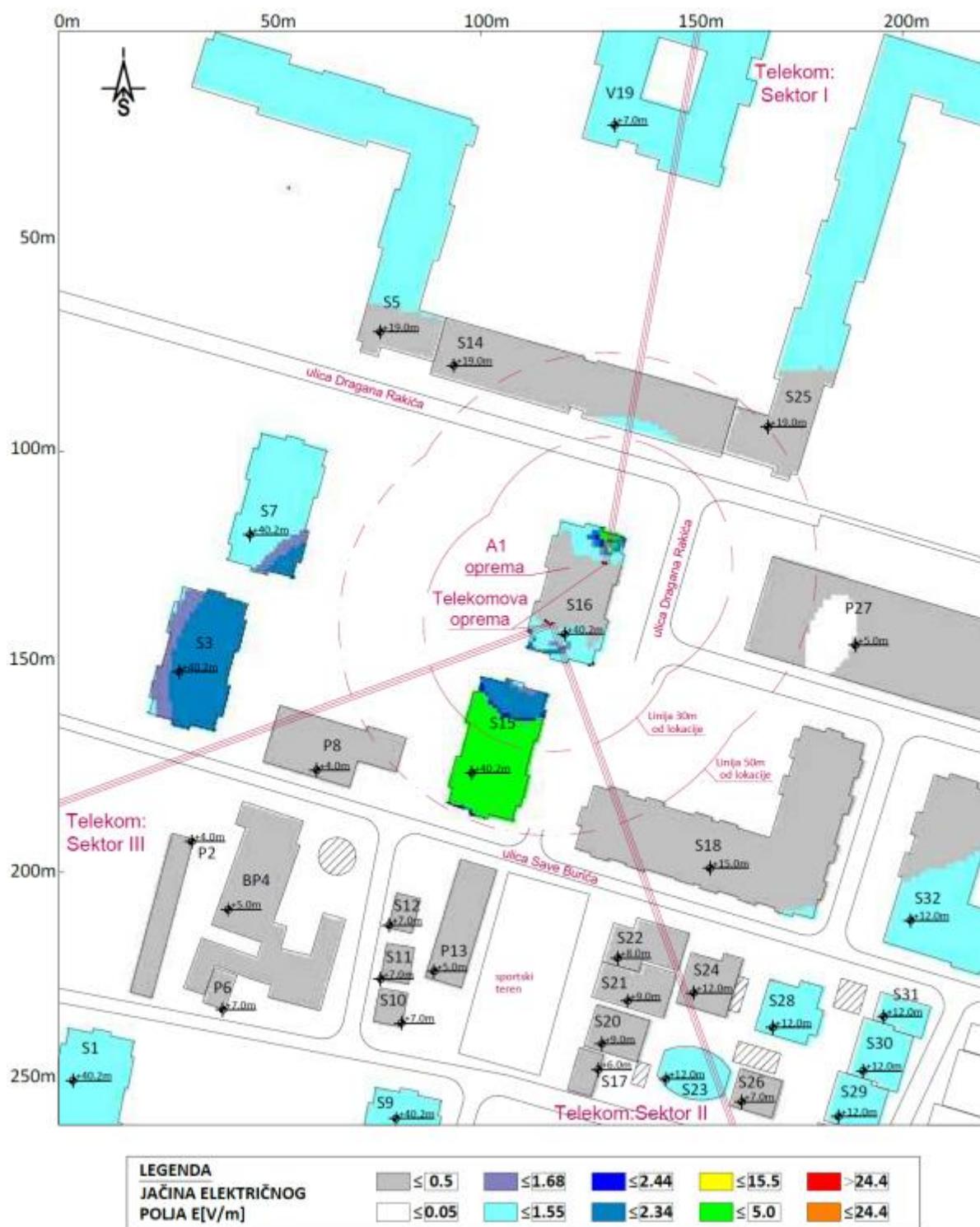
Slika 4.12 Rezultati proračuna jačine električnog polja u objektima na najizloženijim spratovima za slučaj rada sistema UMTS2100/LTE1800/LTE800/LTE2100 operatora Telekom
