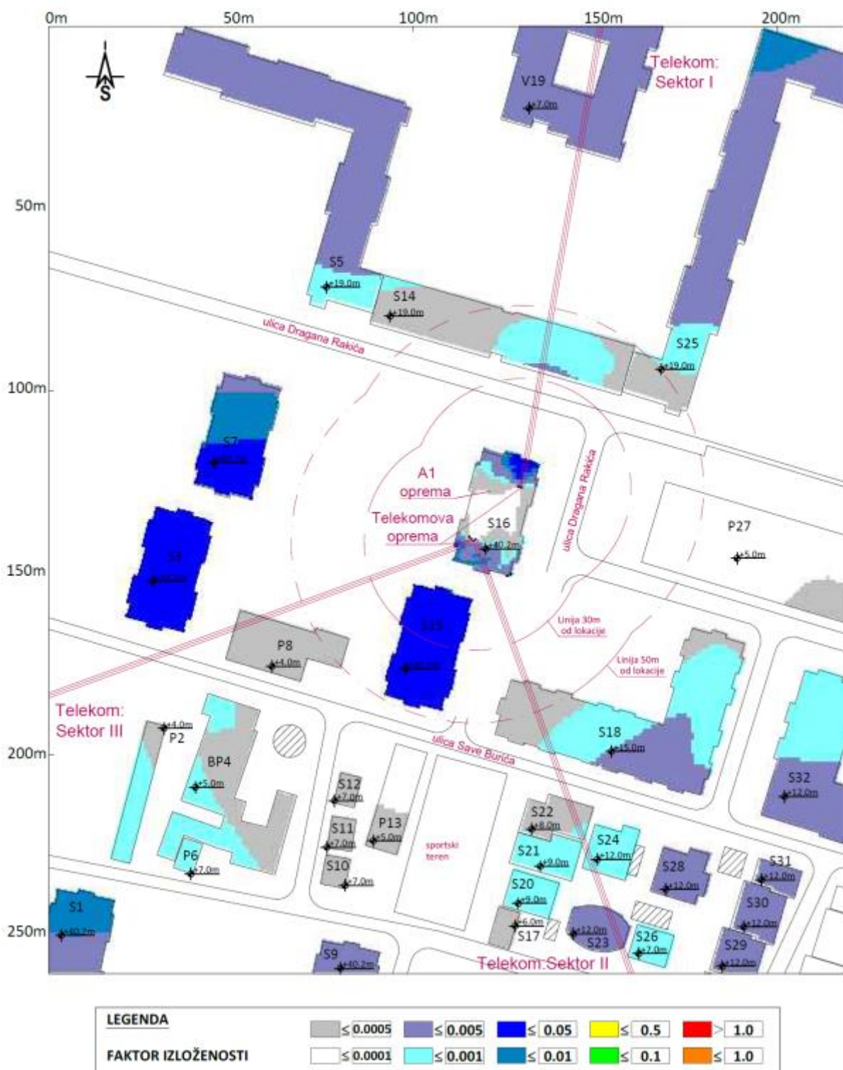
Slika 4.14 Rezultati proračuna ukupnog faktora izloženosti u objektima na najizloženijim spratovima za slučaj rada svih sistema operatora Telekom i A1 Srbija
