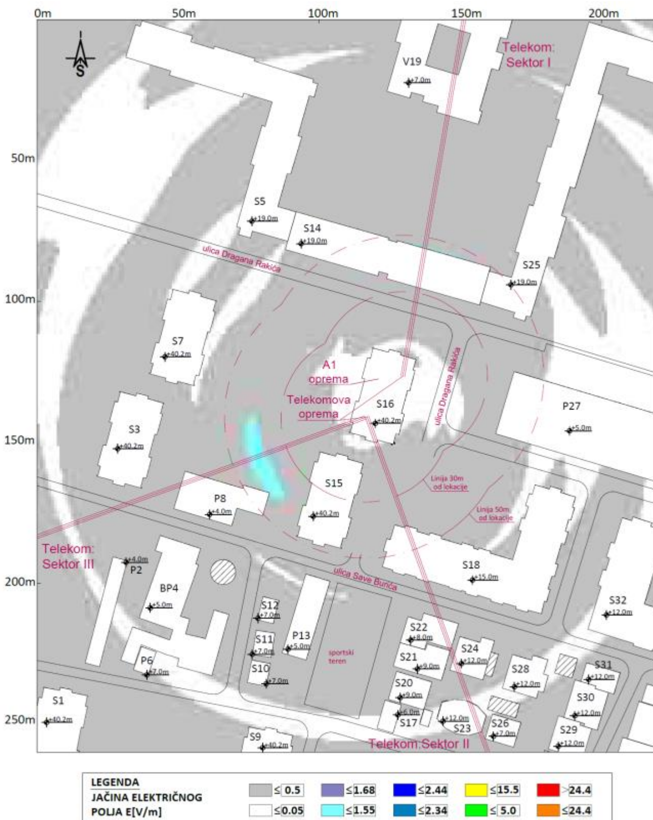
Slika 4.18 Rezultati proračuna jačine električnog polja u široj okolini lokacije bazne stanice na visini +1.70m (prosečna visina čoveka) u odnosu na nivo tla za slučaj rada sistema LTE2100 operatera Telekom. Maksimalna proračunata vrednost jačine električnog polja iznosi E=0.63 V/m.
