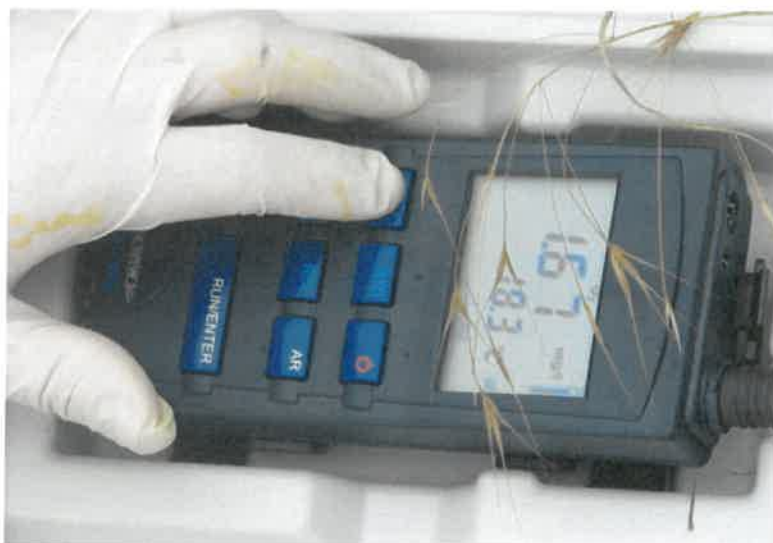
Слика 1. Теренско одређивање концентрације кисеоника
