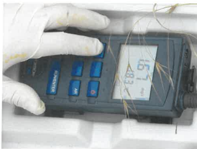
Слика 7. Теренско одређивање концентрације кисеоника
