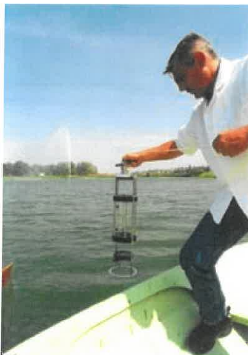
Слика 8. Узораковање воде Friedinger боцом за лабораторијска испитивања
