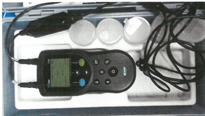
Слика 2. Теренско одређивање концентрације кисеоника
