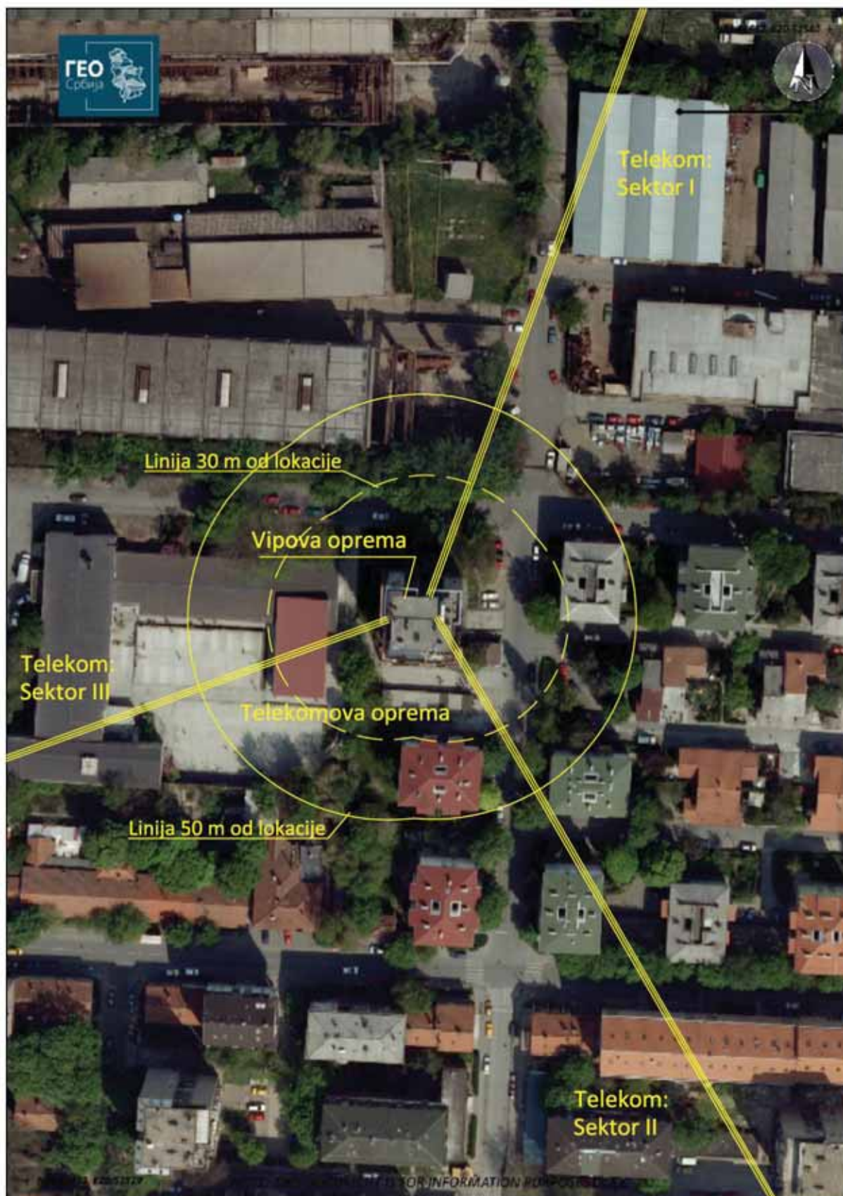
Slika 2.1 Dijagram zračenja radio bazne stanice "BG - Karaburma" – BG53/BGU53/BGL53/BGO53
