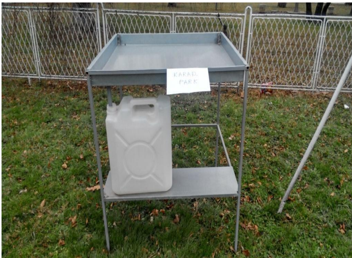
Слика 3. Узоркивач падавина на мерној станици Карађорђевог парка
