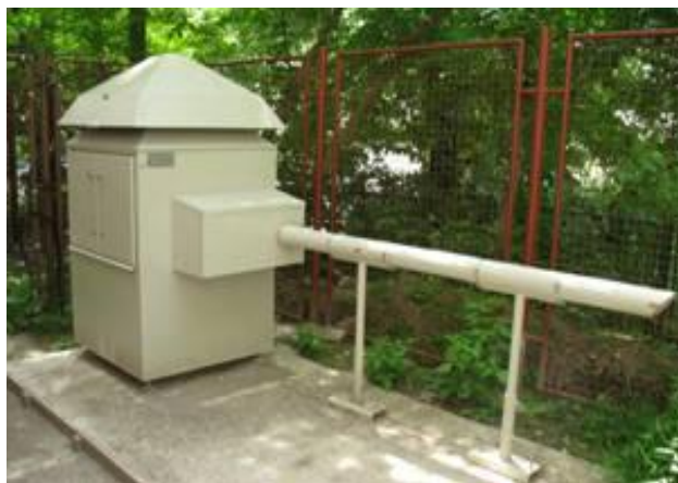
Слика 2. Систем за узимање узорака ваздуха
