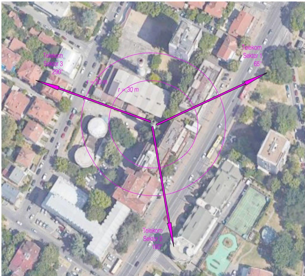
Slika 2.1 Dijagram zračenja radio bazne stanice "BG - Toplana Banovo Brdo" - BG274/BGU274/BGL274/BGO274/BGJ274
