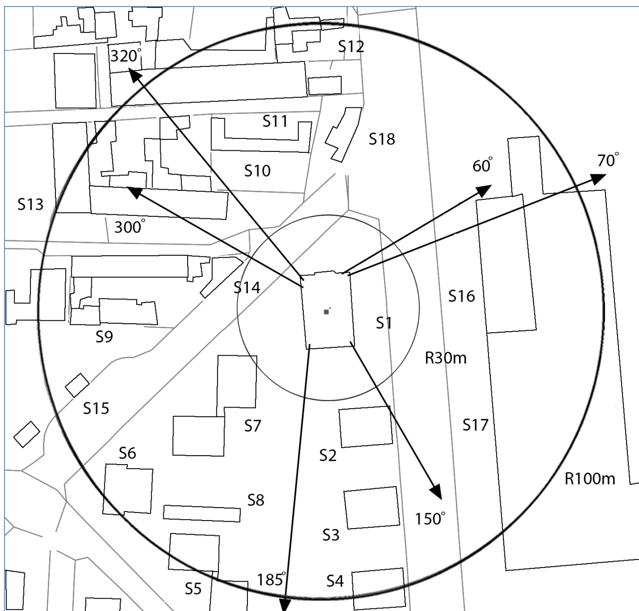
Slika 2.2. Dijagram zone od interesa u okruženju bazne stanice u krugu poluprečnika 100m od antena. Dat je grafik sa objektima i pravcima usmerenja antena a dati su radijusi od 30 i 100m. Ucrtni su azimuti antena A1 70°-185°-320°. Na istom objektu se nalazi i instalacija MTS sa antenskim sistemom usmerenim prema azimutima 60°-150°-300°. Podloga je preuzeta sa portala Geosrbija i ažurirana podacima sa obilaska i aerofoto snimaka. Objekti u okruženju spratnost, visina i pretežna namena objekta je data spiskom u tabeli
