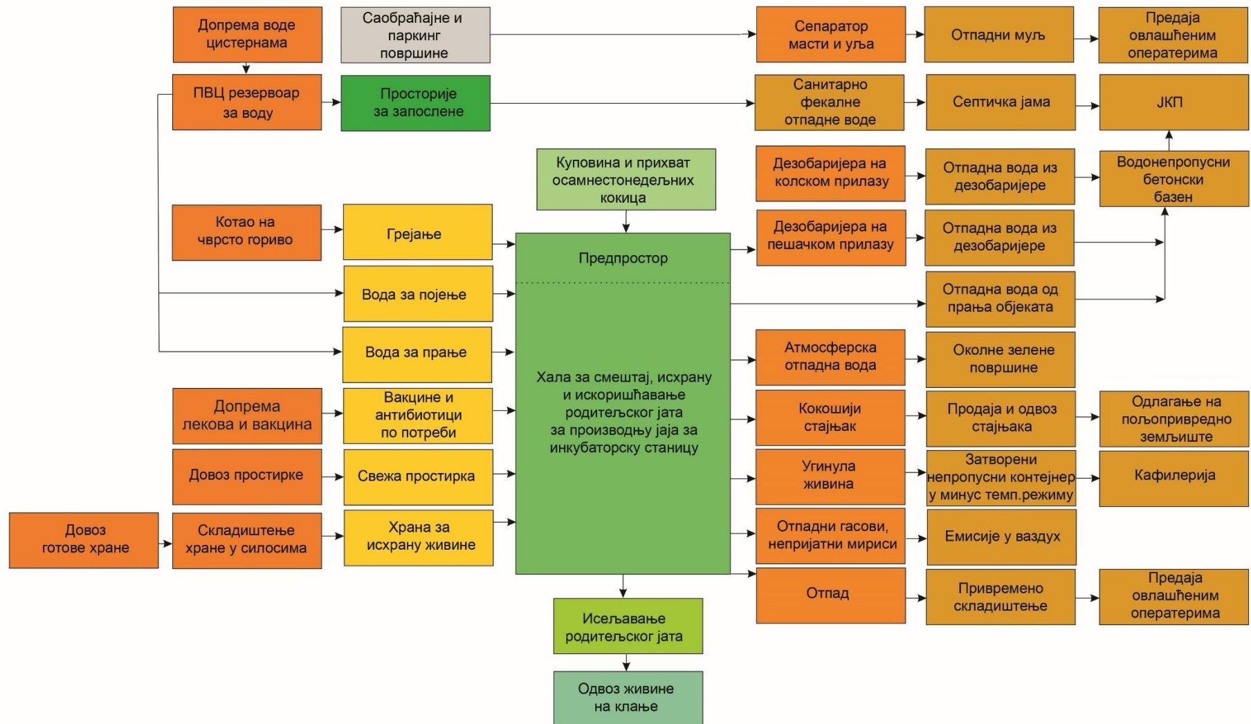
Слика 31. – Шема технолошког процеса фарме за смештај родитељског јата са изворима емисија штетних материја и отпадним токовима
