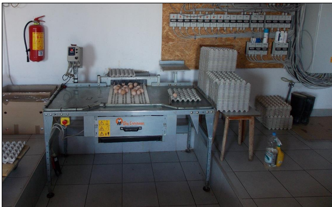
Слика 25. – Сто за ручно купљење јаја инсталиран у постојећем пољопривредном објекту
