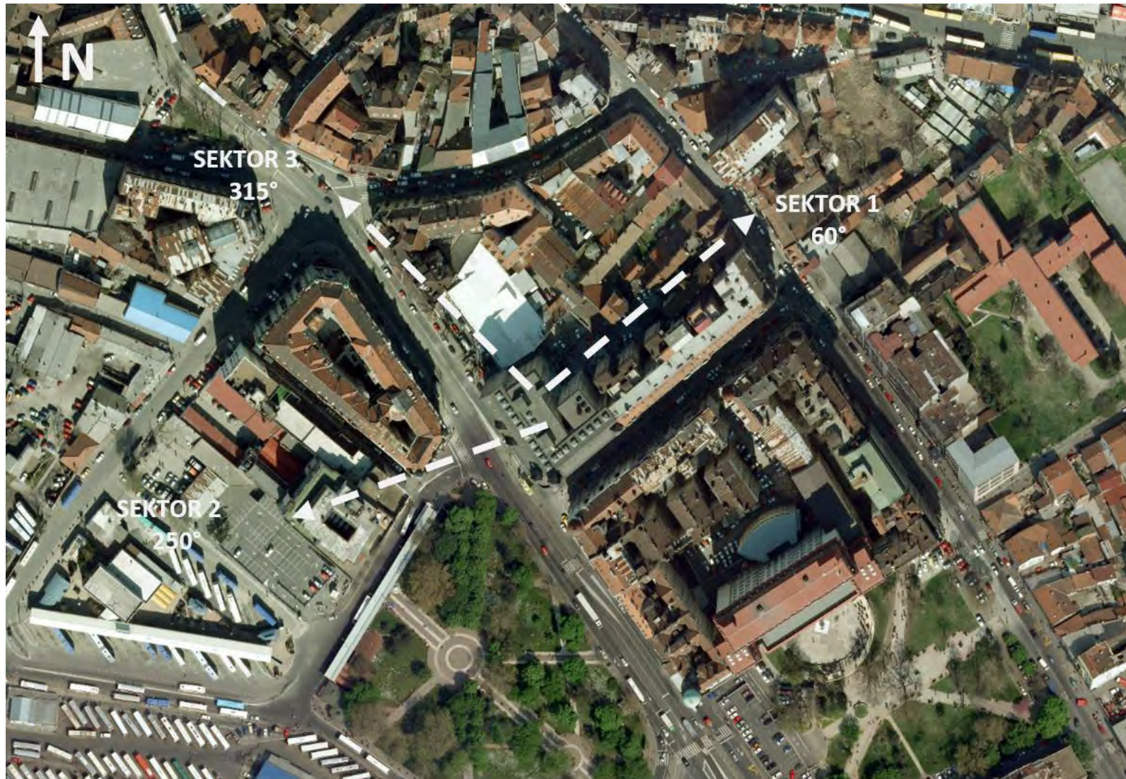
Slika 2.1 Dijagram zračenja radio bazne stanice „BG - Karađorđeva (Nelt)“ - BGU844/BGL844/BGO844
