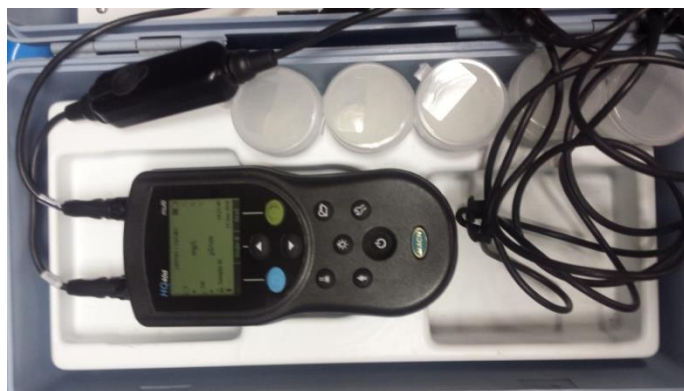
Слика 4. Теренско одређивање концентрације кисеоника
