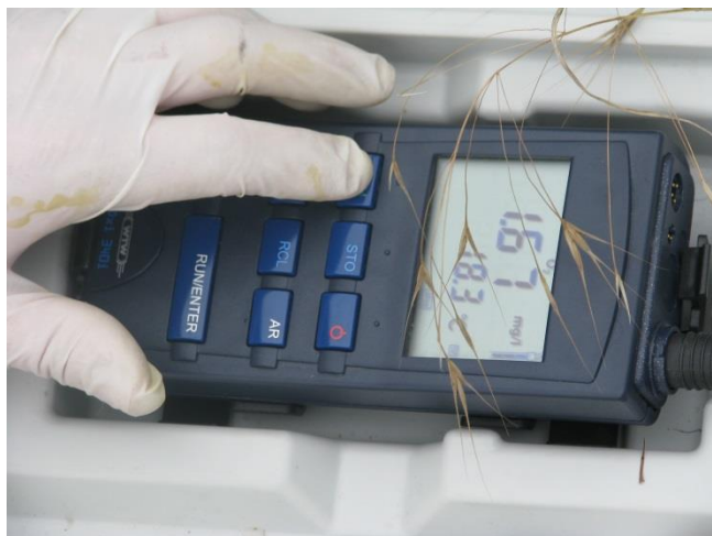
Слика 7. Теренско одређивање концентрације кисеоника
