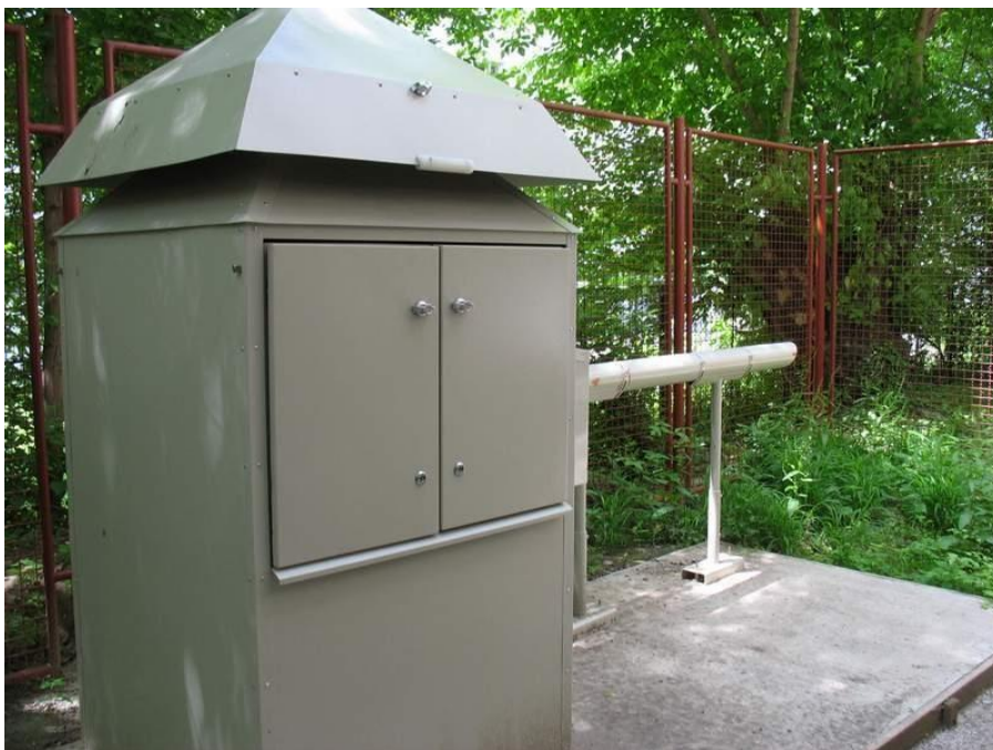
Слика 2. Систем за узимање узорака ваздуха
