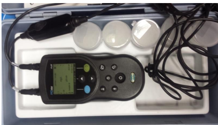
Слика 2. Теренско одређивање концентрације кисеоника
